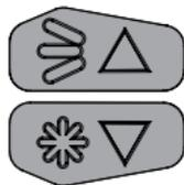
Zum Prüfen im Durchlicht (z.B. Wasserzeichen) halten Sie die **Strahlen-** bzw. **Daumentaste** zuerst gedrückt und halten dann für mehr Licht die daneben liegende **Sterntaste** gedrückt.
