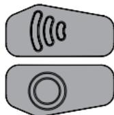
Für die Nutzung der IR-Laser Option muss der Doculus Lumus auf dem Dokument liegen. Halten Sie gleichzeitig die **Wellentaste** und die **Kreistaste** gedrückt. Die linke LED leuchtet bei IR in Rot. Heben Sie das Gerät während der Benutzung nicht an und schauen Sie niemals im aktivierten Zustand von unten in die Öffnung an der Unterseite des Doculus Lumus!
