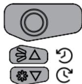
Um das Streiflicht zu verwenden, halten Sie die **Kreistaste** gedrückt. Für Dauerstreiflicht drücken Sie die **Kreistaste 3 x** in schneller Folge. Mit der **Strahlen- bzw. Daumentaste** können Sie das Streiflicht im Uhrzeigersinn rotieren, mit der **Sterntaste** gegen den Uhrzeigersinn. Für eine automatische Rotation halten Sie **Strahlen- bzw. Daumentaste oder Sterntaste für 2 sek.** gedrückt.
